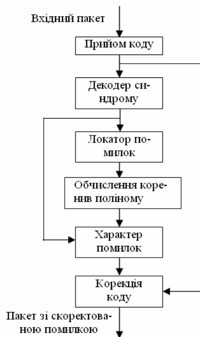
Рис.1. Алгоритм авторегресійного спектрального декодера Ріда-Соломона
