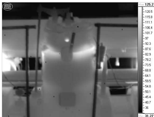
Рисунок 1: Видиме зображення (зліва) та термограма (справа) силового циліндра газомоторного компресора типу 10ГКН
