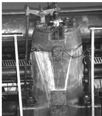
Рисунок 1: Видиме зображення (зліва) та термограма (справа) силового циліндра газомоторного компресора типу 10ГКН
