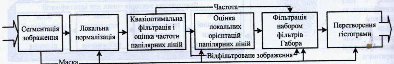
Рис.2. Блок-схема попередньої обробки зображень.
