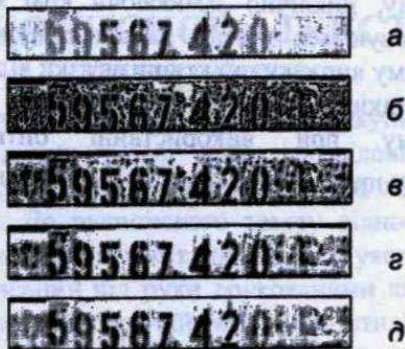
Мал. 3. Нормалізація області: а – вихідне зображення, б – нормалізація області розміром 4x4, в – розміром 8x8, г – розміром 16x16, д – розміром 64x16.
