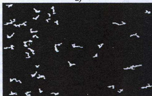
Рис.8. Фільтрація лінійних сегментів з використанням різних порогів: а) поріг рівний 1, б) поріг рівний 3.
