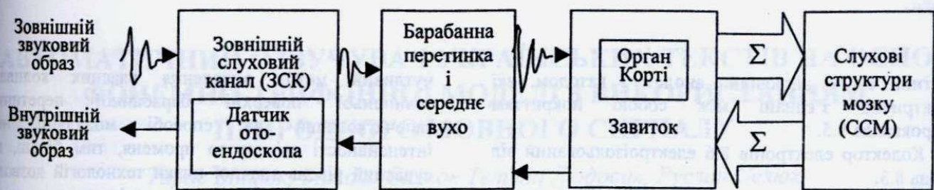
Рис. 1. Структурно-функціональна схема системи виявлення звукових сигналів, що емітуються органом Корті
