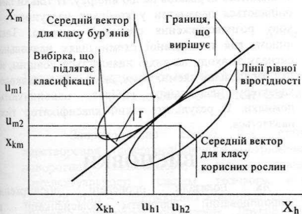
Рис. 3. Геометрична інтерпретація класифікації в двовимірному просторі ознак.
