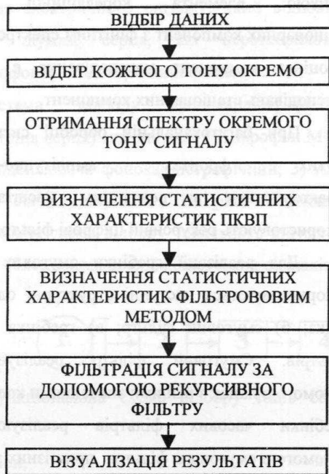
Рис.2. Блок-схема дослідження тонального сигналу.
