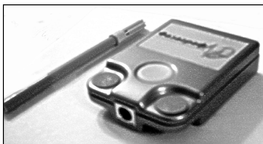
Рис. 6.18. Внешний вид микропроцессорного регистратора ЭКГ с пальцевыми электродами
